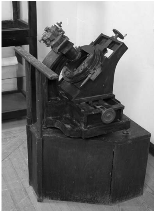
Figure 9.9. Machine à mesurer les clichés de la Carte du Ciel de l'observatoire d'Alger.
