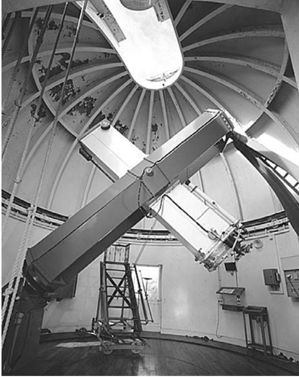
Figure 9.1. Vue actuelle de l'équatorial photographique de l'observatoire de Bordeaux. On distingue au second plan l'escalier mobile qui permet à l'astronome d'effectuer réglages et observations.
