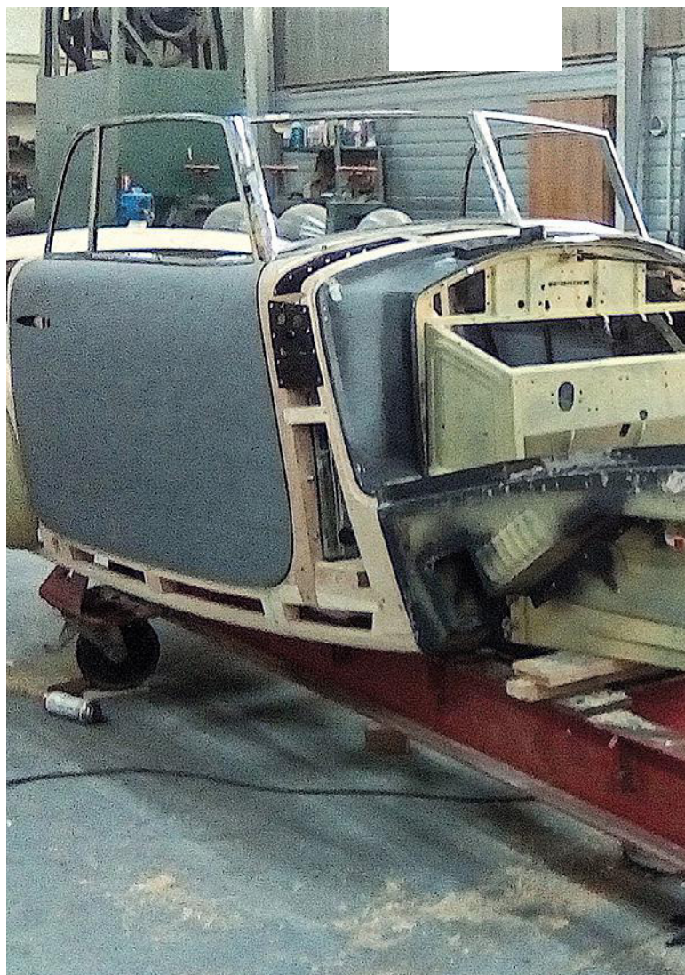
➡ L'ossature en bois de la partie arrière elliptique, appelée « pointe Bordino », est usinée en plusieurs parties. Cet ouvrage d'ébénisterie est un chef-d'œuvre.
