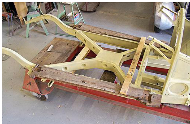
➡ Le « tôlier » se charge du châssis. Après sablage, il a refait les parties corrodées. Puis le compagnon a appliqué un apprêt anti-rouille, suivi d'une peinture spéciale carrosserie.
