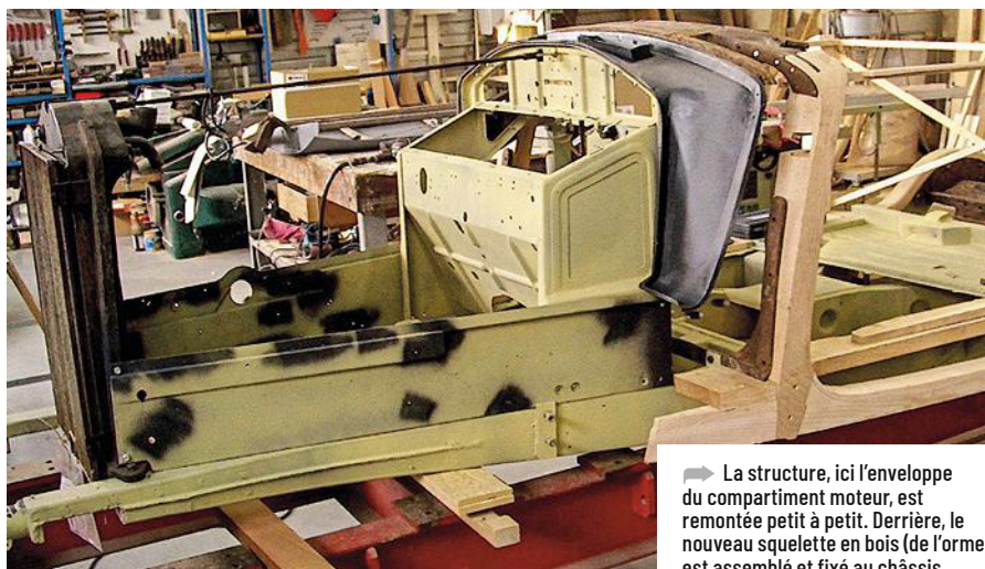
➡ Le « tôlier » se charge du châssis. Après sablage, il a refait les parties corrodées. Puis le compagnon a appliqué un apprêt anti-rouille, suivi d'une peinture spéciale carrosserie.
