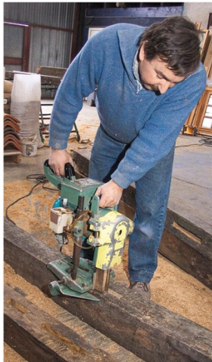
4 Creusez les mortaises avec une mortaiseuse à chaîne. L'outil est bridé sur le poteau à l'aide d'un dispositif de serrage intégré.
