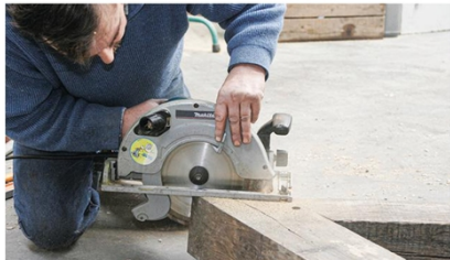
5 Utilisez les tenons en commençant à la scie circulaire pour réaliser les arasements. Les côtés du tenon peuvent être dégagés au ciseau à bois après avoir réalisé plusieurs traits de coupe rapprochés.
