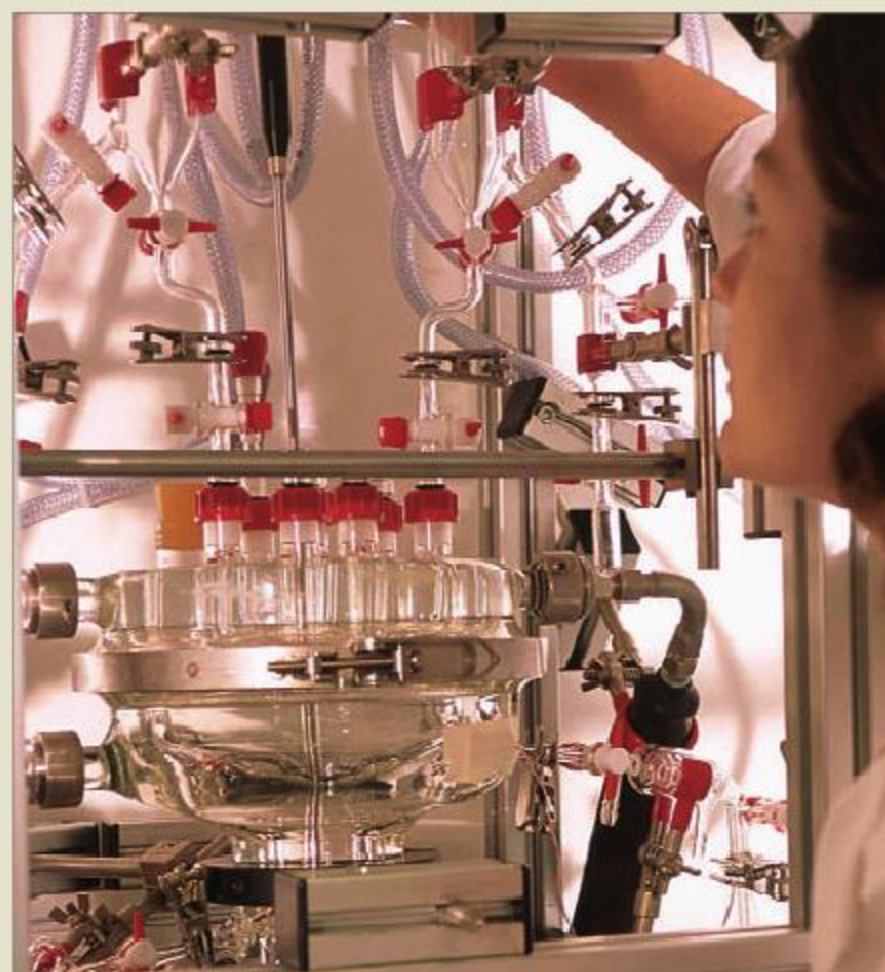
Décomposition de l'eau par cycle thermochimique au Commissariat à l'énergie atomique (CEA), à Saclay.
