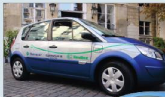
La Cleanova est basée sur une voiture thermique alors que la BlueCar a été conçue dès le début pour l'électricité.
