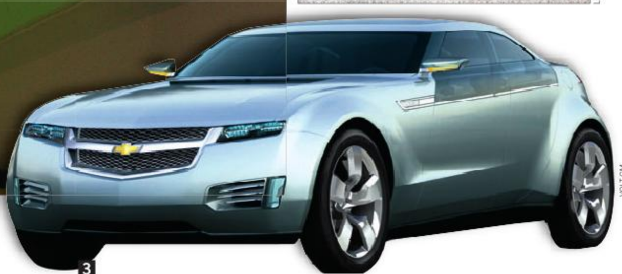
Trois constructeurs, trois stratégies : diesel électrique chez Peugeot (1), essence électrique à 4 roues motrices chez Lexus (2), hybride plug-in pour Chevrolet (3).
