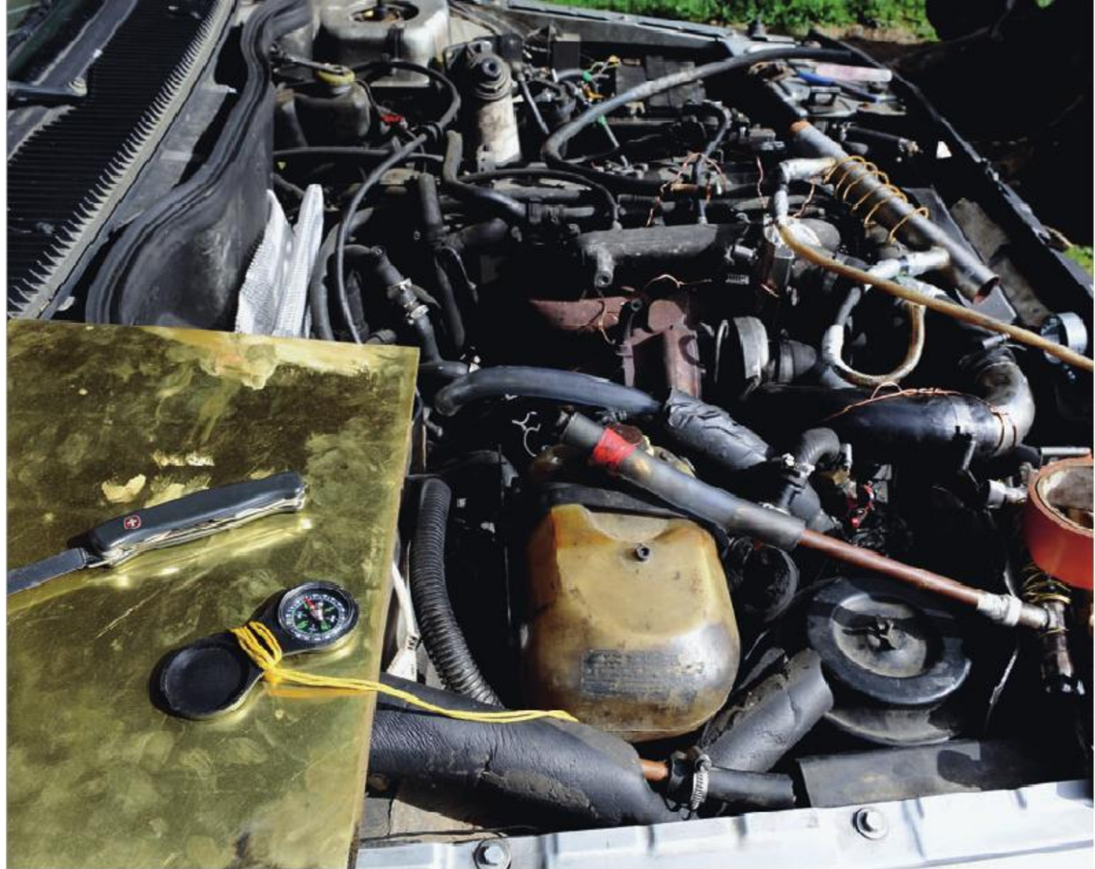
Moteur modifié avec un système Gillier-Pantone. La boussole montre que certaines pièces ont été magnétisées.
