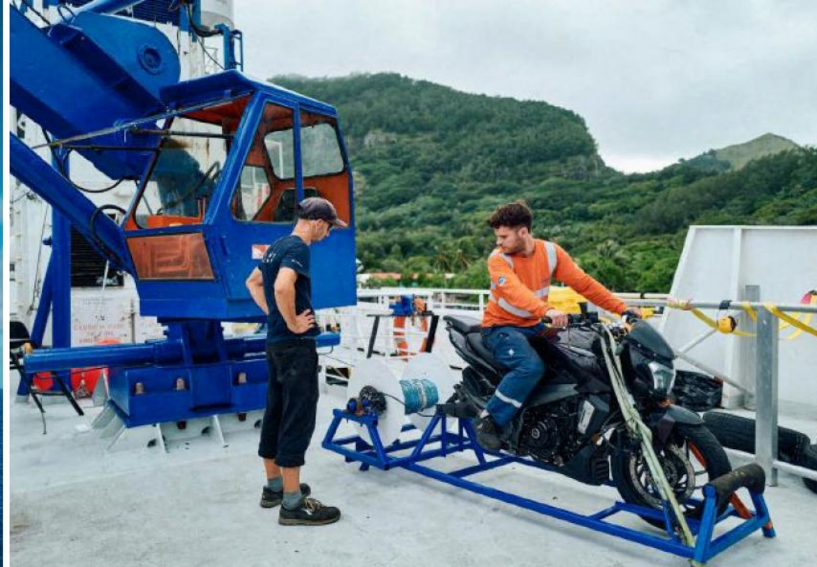
Sur le pont, une moto sert de treuil en enroulant un câble relié au parachute ascensionnel.
