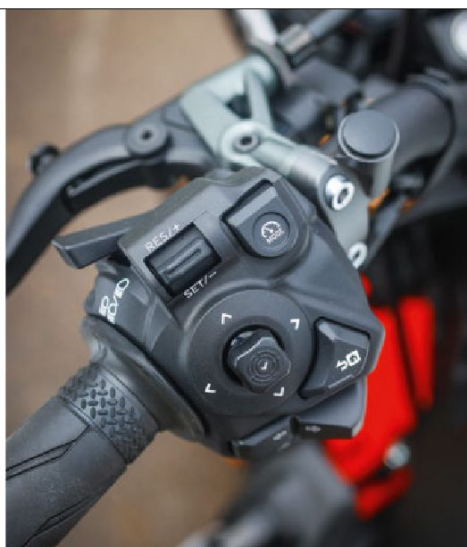
Les commandes au guidon démontrent un véritable sérieux d'équipement, entre commodos complets et leviers réglables par petite molette.
