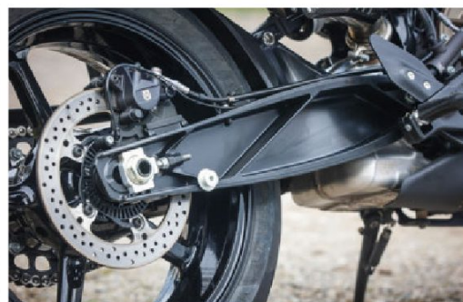
Le bras oscillant de la KTM Duke 790 est lui aussi repris, un bras au design original et à la rigidité incontestée.
