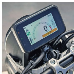
Le tableau de bord de la Honda CB 1000 F est de type TFT : fini les aiguilles comme sur les motos de Freddie Spencer !
