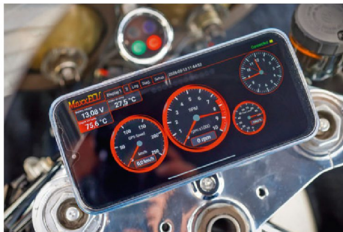
Anachronique, le téléphone portable qui fait office de tableau de bord est connecté au calculateur MaxxECU, avec de multiples infos.
