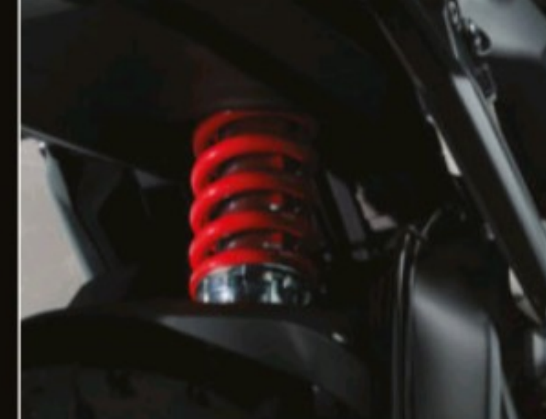
Le combiné arrière Showa est nouveau. Il offre 130 mm de course et un double réglage de la précharge du ressort et de la détente hydraulique.
