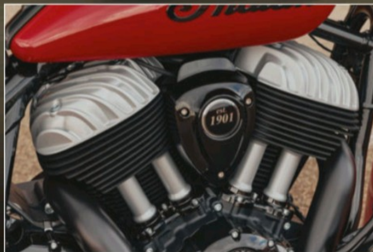
Le V-twin de presque 1 900 cm 3 refroidi par air est moderne avec son double arbre à cames et ses 4 soupapes. Il développe 90 ch et 15,9 mkg.
