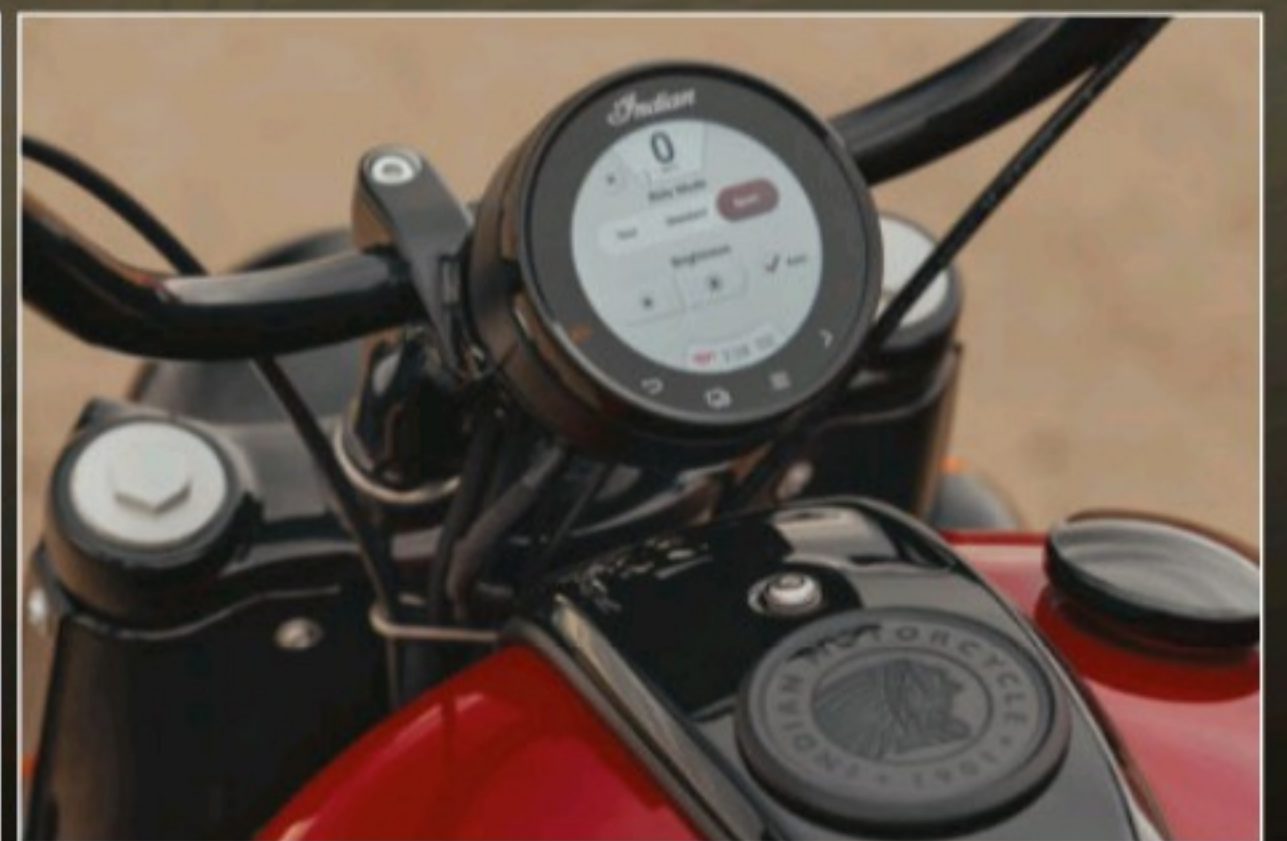
Le compteur de 4 pouces est connecté et tactile. Pratique pour utiliser la navigation qu'il intègre via l'appli Indian.
