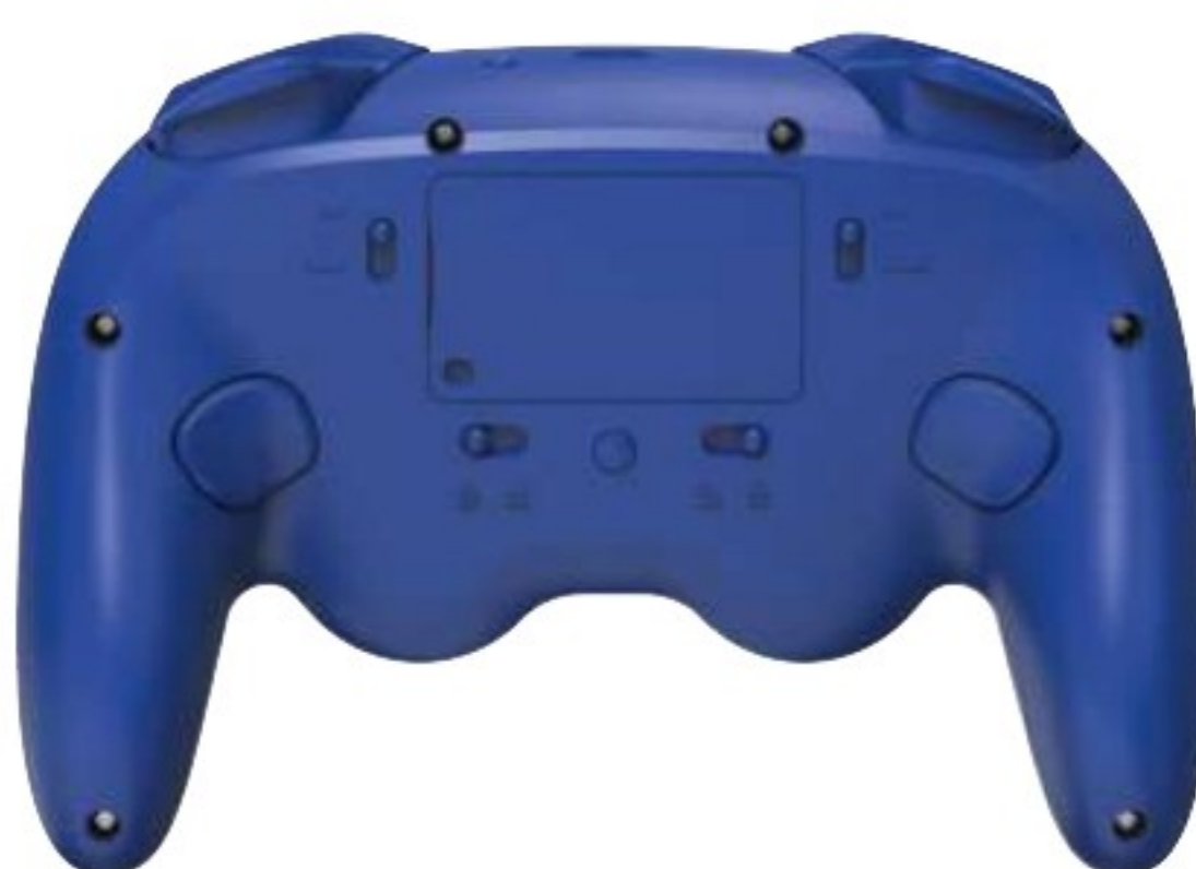
▲ Sur la face arrière, on trouve la condamnation des boutons d'annulaire.
