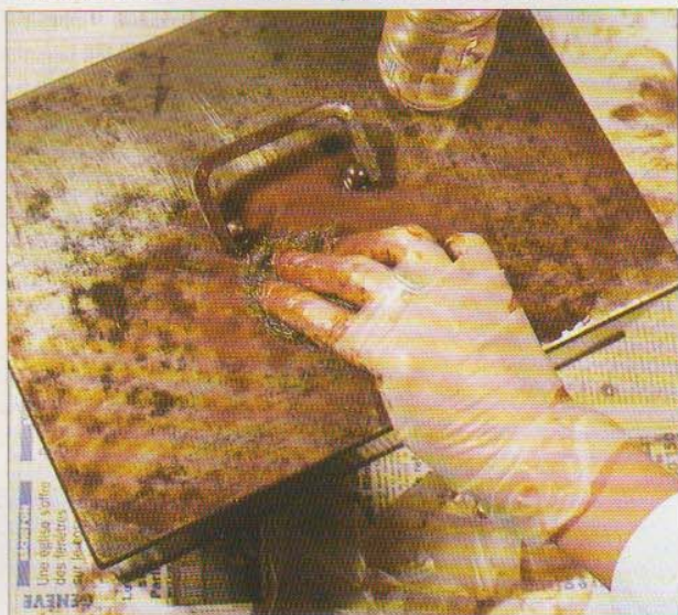
Décapage au tampon métallique et lubrification à l'huile minérale
