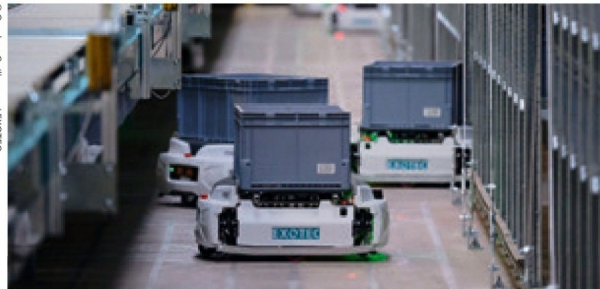
191 robots Skypod s'activent dans l'installation mise en place par Exotec sur le site Renault Group de Villeroy. Il s'agit de la version 1 du robot mis au point par le Français.
