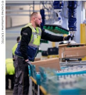
Les robots apportent les bacs contenant les pièces détachées aux opérateurs chargés du picking. Le site de Villeroy dispose de 14 stations de picking.
