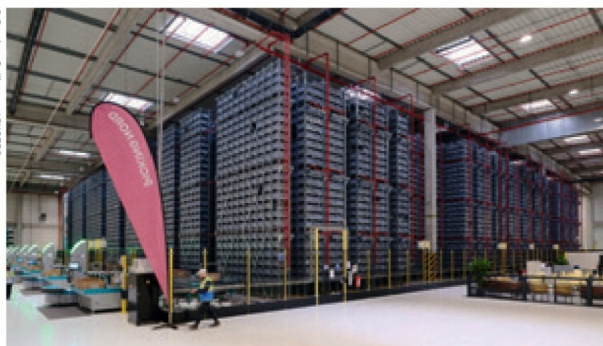
Le système Skypod installé par Exotec à Villeroy gère 19 000 références de pièces (SKU) et stocke 3,3 millions de pièces. En 2025, il a servi 3,5 millions de demandes.
