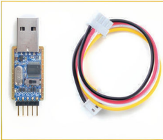
Le convertisseur USB-série est un accessoire de débogage indispensable. Ayez-en toujours un dans votre sac !
