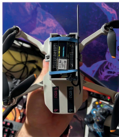
Prototype V2 avec boîtier imprimé en 3D : Remarquez l'ajout de l'antenne Wi-Fi externe soudée directement sur l'ESP8266
