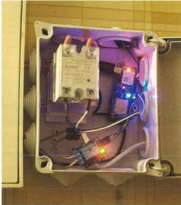
Fig. 3 : L'installation avec notre microcontrôleur connecté aux deux relais.
