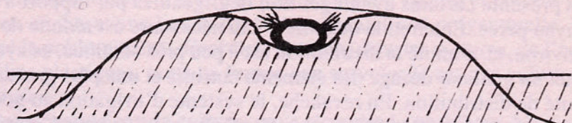
Position du tuyau percé pour l'irrigation sous paillage ; noter les trous placés sur la partie médio-supérieure
