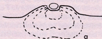
Infiltration de l'eau d'un tuyau percé : a) terrain peu perméable ; b) terrain très perméable
