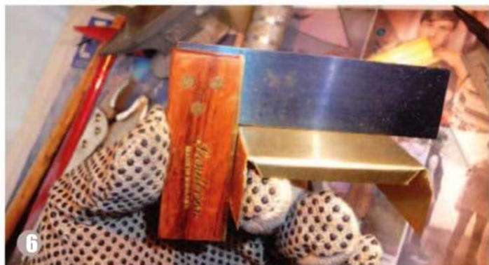
Photos 6, 7 & 8 : Confection par pliage et soudure de tôle de laiton, de la caisse sous la cabine.
