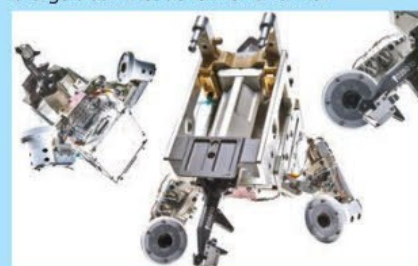
À bord du module se trouvent les outils coupe-fil, à buse, multifonction et d'enlèvement de bouchons de sécurité
