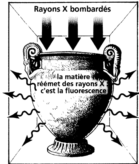
28 | Grâce aux analyses physico-chimiques, il a été possible de retrouver comment le cratère de Vix avait été assemblé, ainsi que l'origine et la situation géographique des pièces de métal forgées et façonnées.
