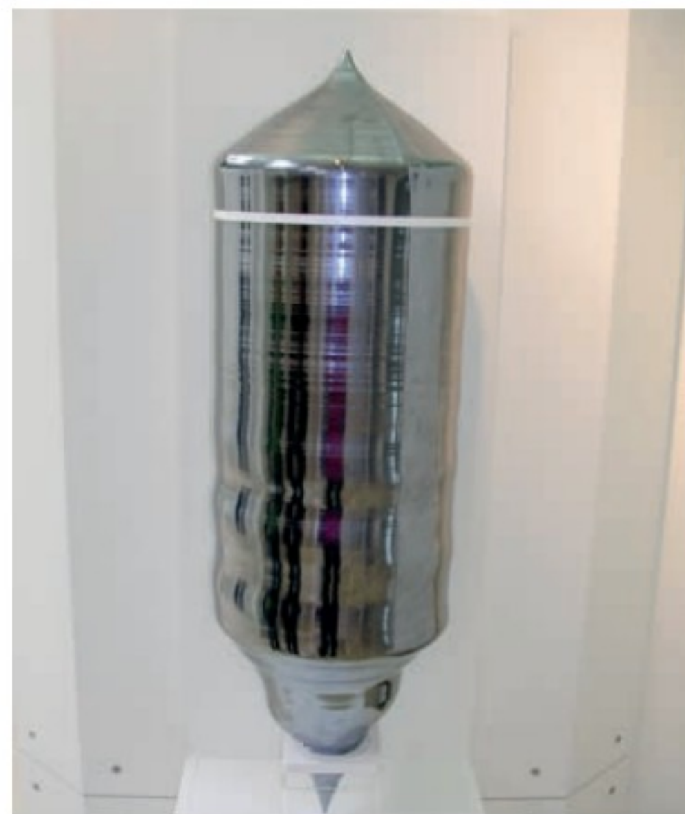
Ce sont ces gros cristaux de silicium ultra pur que l'on découpe en tranches pour y graver des semi-conducteurs. (Photo CC Massimiliano Lincetto)
