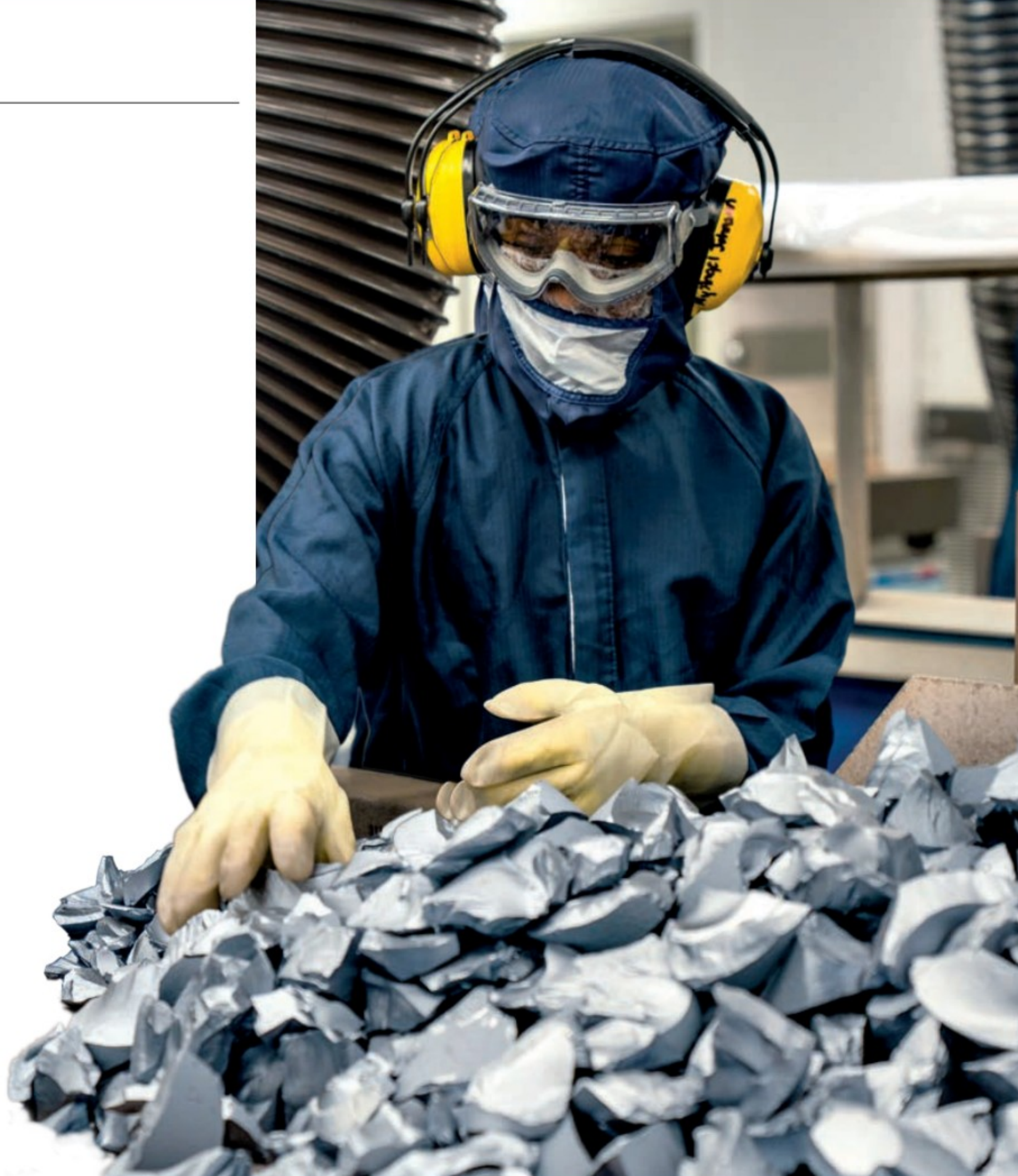
Du silicium métallurgique en cours de traitement chez Hemlock. (Photo : Hemlock Semiconductor)
